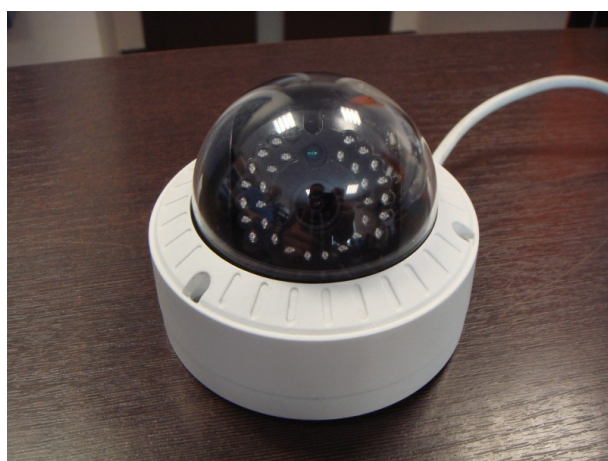
dopuszczalne pochylenie – wszystkie diody są ponad obudowę
