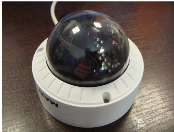
dopuszczalne pochylenie – wszystkie diody są ponad obudowę
