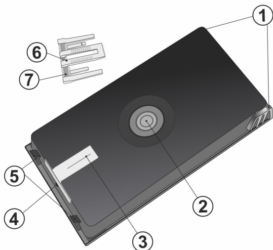
Rys. 1: Przycisk napadowy na jego platformie montażowej: 1. Zawiasy 2. Przycisk A 3. Czujnik B 4. Śruba mocująca płytę tylną 5. Zaczepy platformy montażowej 6. Wymienny zacisk banknotów lub dokumentów 7. Prowadnica wskaźnika
