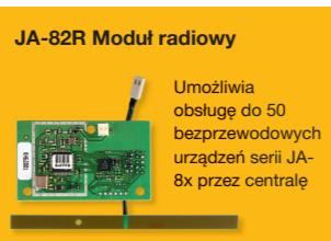
**JA-82R Moduł radiowy**
